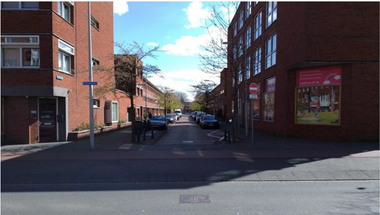
**Kempstraat Ecke Graskopstraat in Den Haag**, die Fahrradfurt verläuft auf unveränderter Höhe über die Einmündung, zur Fahrbahn wird sie durch Schrägbordsteine abgegrenzt.
