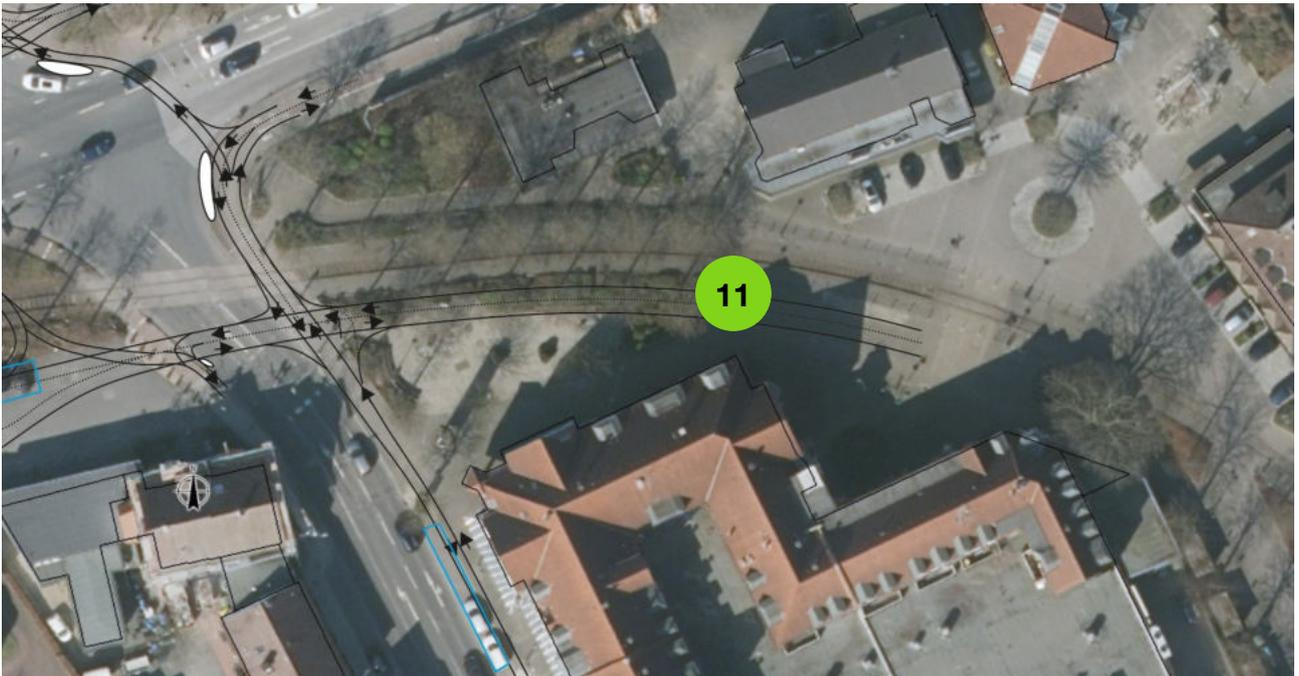
Fokus: Konfliktpunkt 11 „L107 zwischen Bahnhof und Tunnel“ – alternative Führung des Radverkehrs parallel zu den Gleisen.
