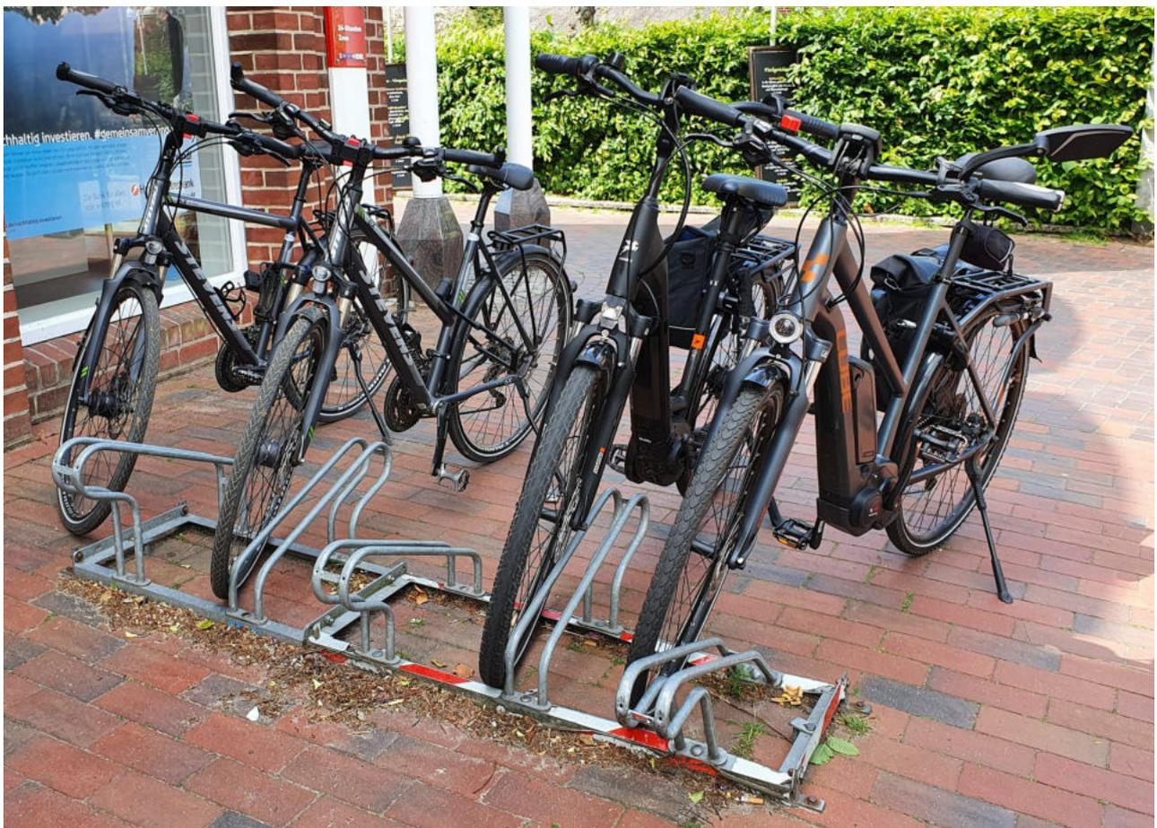
Klassische Felgenbrecher: Das Fahrrad soll mit dem Vorderrad in den meist zu eng angeordneten und für moderne Fahrräder viel zu schmale Halterungen "eingeklemmt" werden. Wenn ein Fahrrad kippt, können die Felgen schnell verbiegen. Wie hoch die Akzeptanz bei Radfahrenden mit hochwertigeren Fahrrädern ist, kann man auf diesem Bild erkennen.
