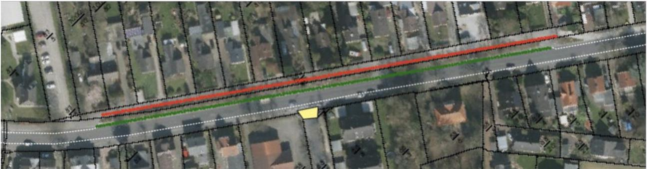
Dabei soll für die Querung je Richtung eine Durchfahrt für den Radverkehr geschaffen werden. In diesem Bereich wird der Parkbereich auf der Fahrbahn unterbrochen und eine Sperrfläche eingerichtet.
