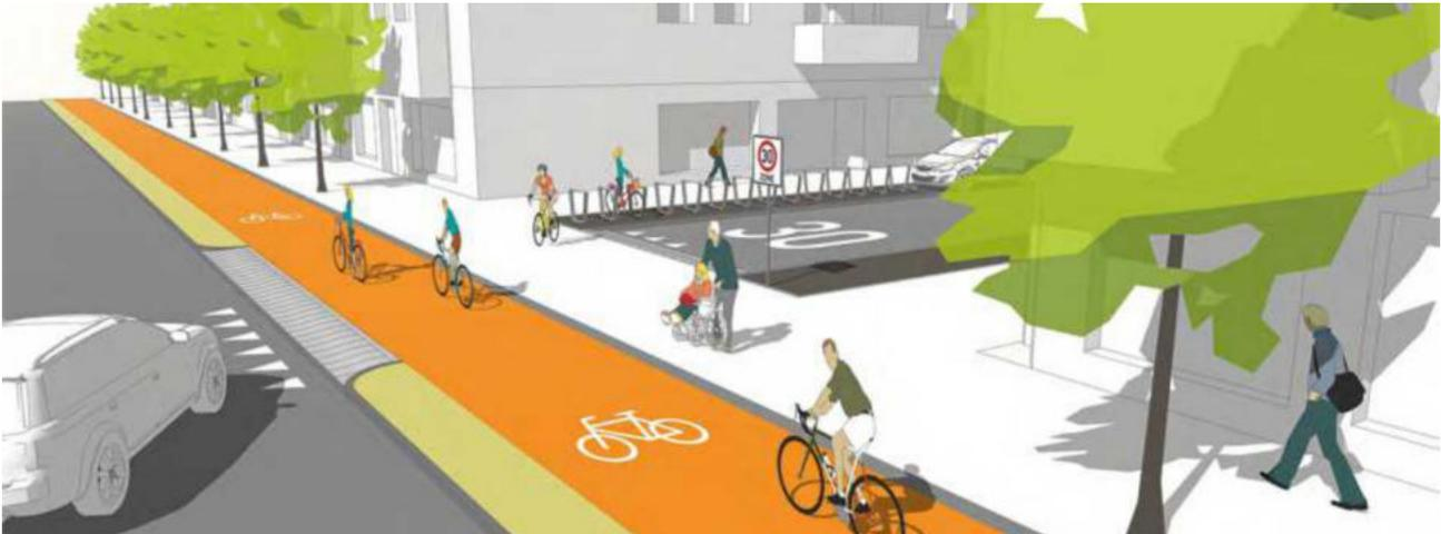
**Aufpflasterung:** Durch eine Aufpflasterung verlangsamt sich der kreuzende Verkehr und der Vorrang der Radfahrenden wird hervorgehoben. (Quelle: ADFC InnoRAD, Timm Schwendy)
