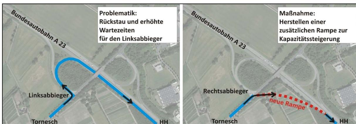
Bild 4.7: Konzeptskizze – Erweiterung der Anschlussstelle, Hauptstrom morgens (M 4)
