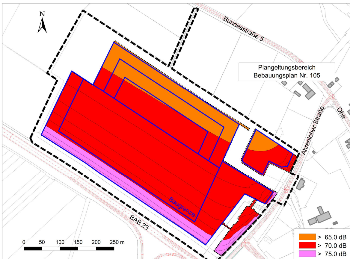
Abbildung 6 - maßgeblicher Außenlärmpegel für schutzbedürftige Räume
