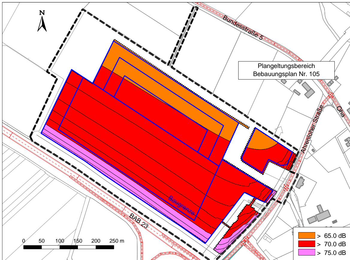
Abbildung 1: maßgeblicher Außenlärmpegel für schutzbedürftige Räume
