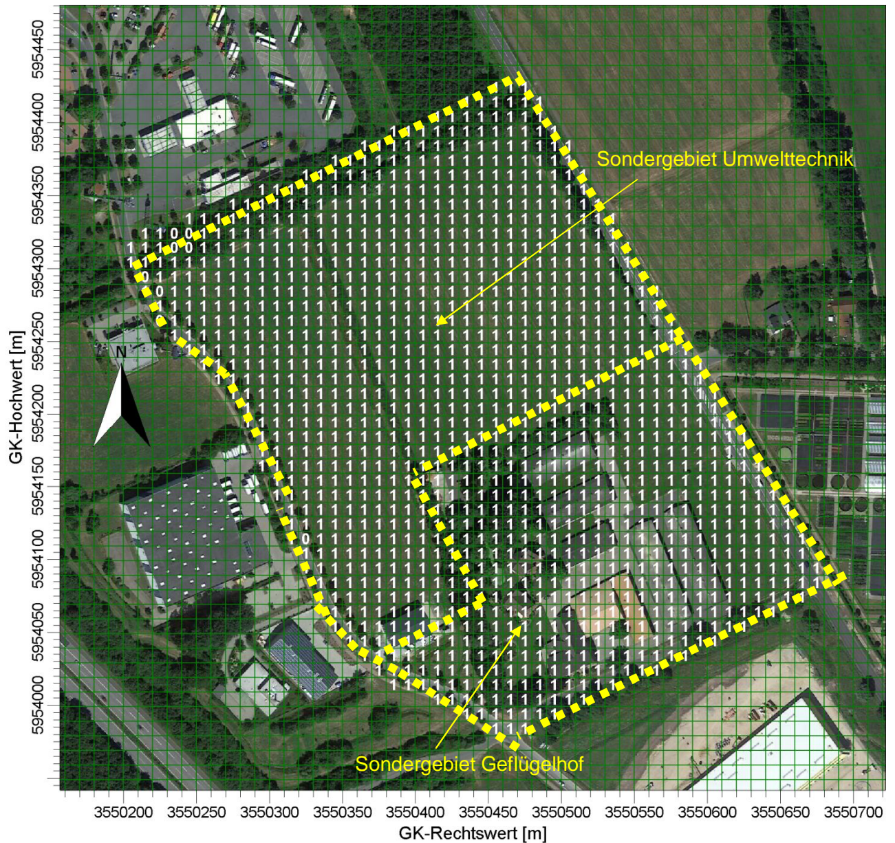
Abbildung 6: Geruchsimmissionen ohne Berücksichtigung der Quellen des Geflügelhofes neumann im Bereich des Plangebietes B-Plan 47 nördlich des Asperhorner Weges in Tornesch
