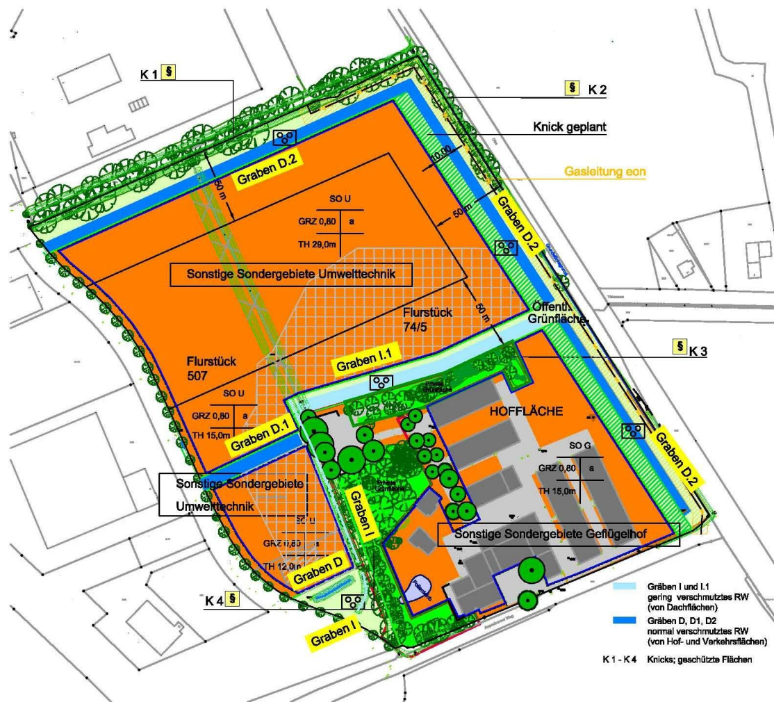
Übersichtsplan zum Umweltbericht - Knicks und Gräben, basierend auf dem B-Plan und dem Wasserwirtschaftskonzept (ohne M.)
