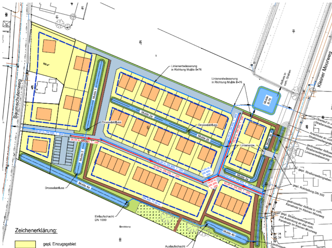
Abbildung 6 - Lageplan Entwässerungskonzept (ohne Maßstab), Stand 19.06.2015, von dänekamp und partner, Pinneberg
