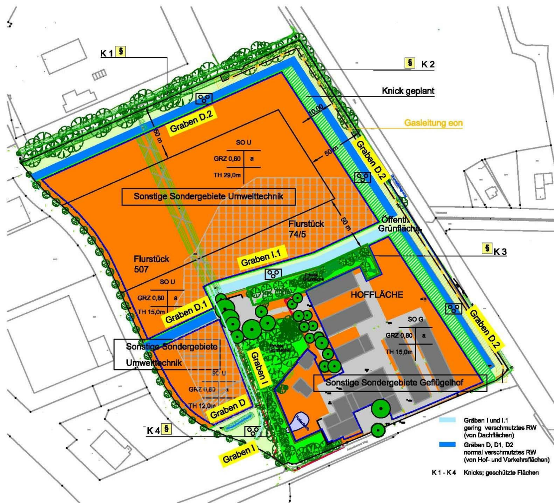
Übersichtsplan zum Umweltbericht - Knicks und Gräben, basierend auf dem B-Plan und dem Wasserrwirtschaftskonzept (ohne M.)
