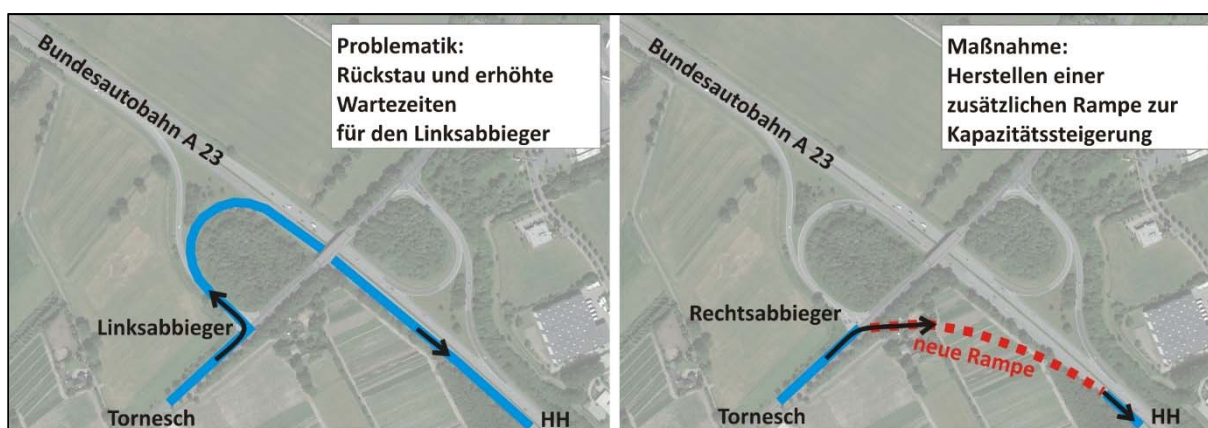
Bild 4.8: Konzeptskizze – Erweiterung der Anschlussstelle, Hauptstrom morgens (M 5)
