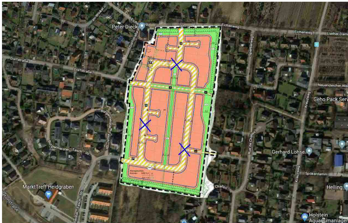
Abbildung 7 - Lageplan mit Kennzeichnung der zusätzlich geplanten Hydranten
