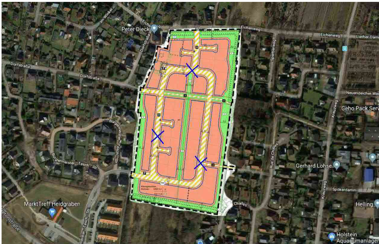
Abbildung 11 - Lageplan mit Kennzeichnung der zusätzlich geplanten Hydranten
