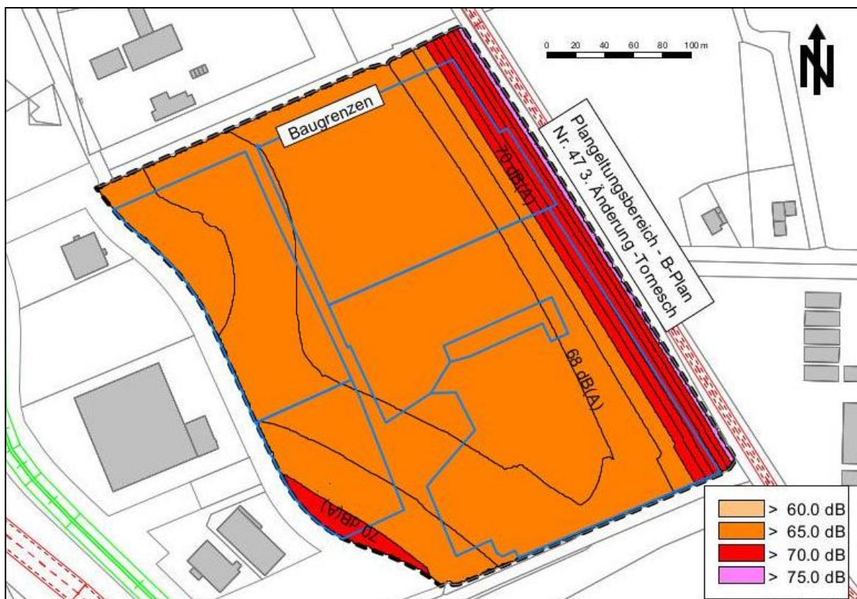
Abb.2: Maßgeblicher Außenlärmpegel für Räume, die überwiegend zum Schlafen genutzt werden (Lairm Consult GmbH, Oktober 2019)
