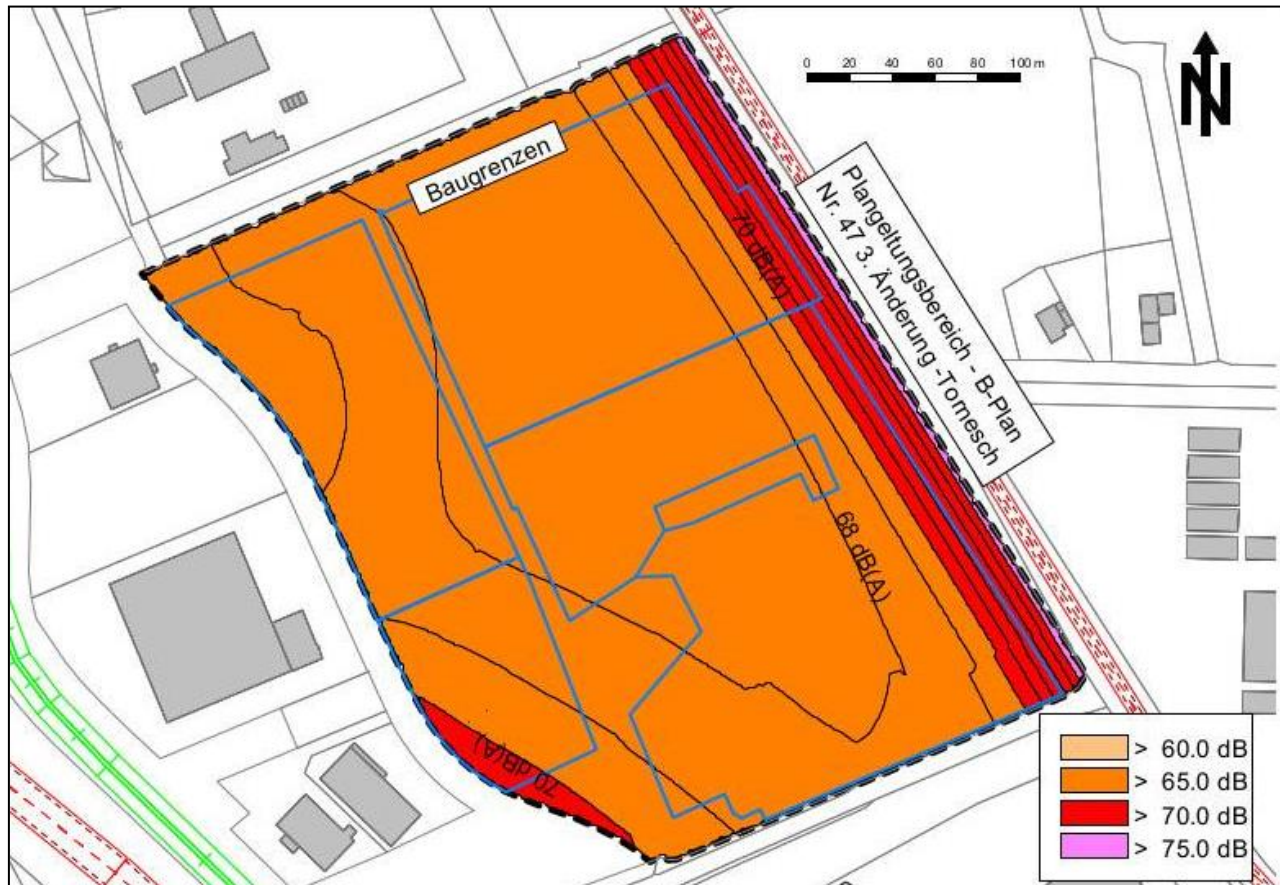
Abbildung 8 – Maßgeblicher Außenlärmpegel für Räume, die überwiegend zum Schlafen genutzt werden (Lairm Consult GmbH, Oktober 2019)
