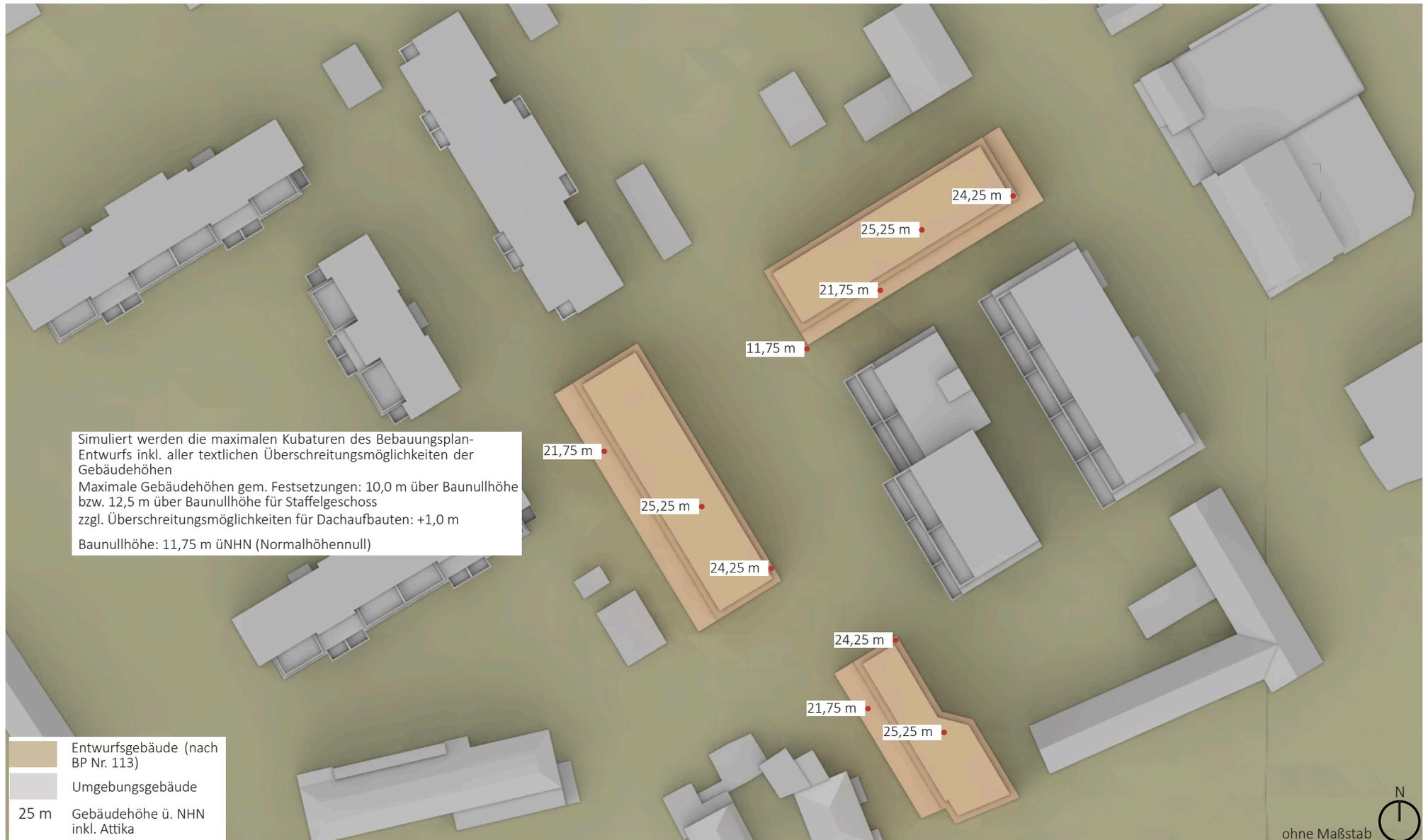
Abb. 14: Gebäudebezeichnung und Modellhöhenplan - Gebäudehöhen inkl. Attika bzw. Brüstung entsprechend nach Bebauungsplan Nr. 113 (Eigene Darstellung, Digitales 3D-Gelände- und Gebäudemodell: Landesamt für Vermessung und Geoinformation Schleswig-Holstein ©GeoBasis-DE/LVermGeo SH/CC BY 4.0, Aktualität 30.08.2021; Planungsrechtlicher Entwurf nach Bebauungsplanentwurf Nr. 113 Stadt Tornesch, Architektur + Stadtplanung, Stand 08.08.2023)
